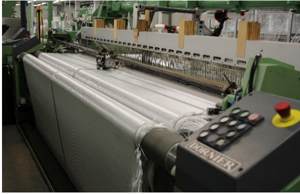
Obrázek 12: Tkací stroj Dornier PTS 1/S a listový prošlupní mechanismus Stäubli.
