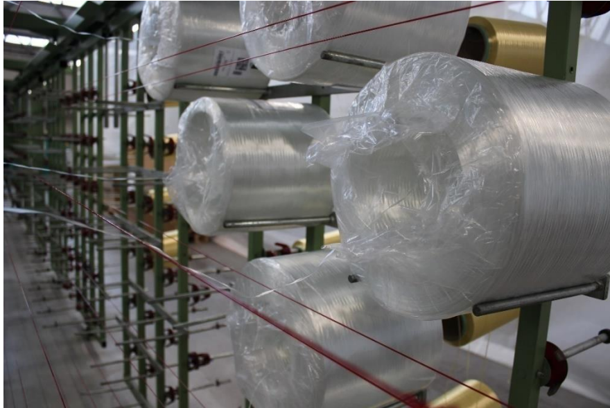
Obrázek 18: Vložené cívky do trnů v cívečnici.
