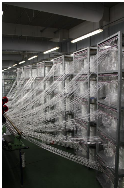
Obrázek 15: Rozmístění stojanů za tkacím strojem.
