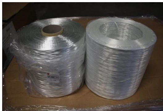
Obrázek 14: Cívka s návínem na papírové dutince a cívka s vnitřním odvíjením.
