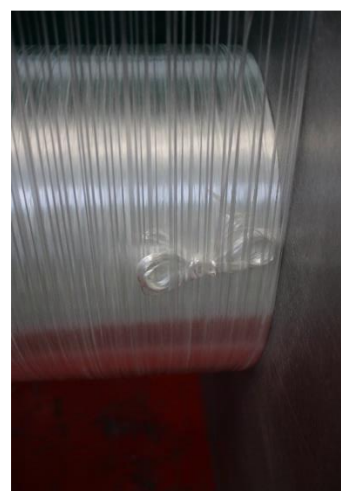
Obrázek 22: Přetržená nit během stáčení pásů na osnovní vál a vložené klubko přetržené nitě do osnovy.
