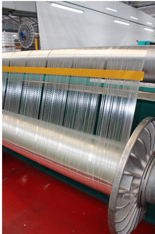
Obrázek 23: Výsledná osnova se zafixovanými nitěmi a nitovým křížem.
