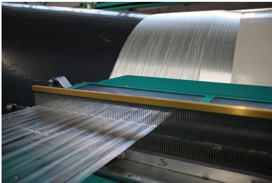
Obrázek 20: Snování pásu na snovacím stroji Karl Mayer OOM 3600.
