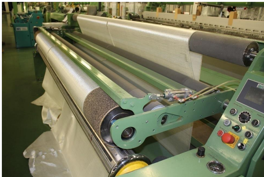
Obrázek 13: Navíjecí ústrojí MTS typ ZS 4000.
