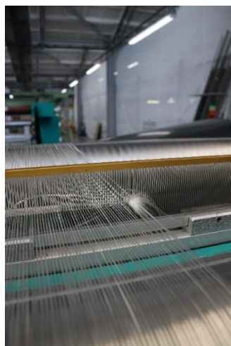
Obrázek 22: Přetržená nit během stáčení pásů na osnovní vál a vložené klubko přetržené nitě do osnovy.
