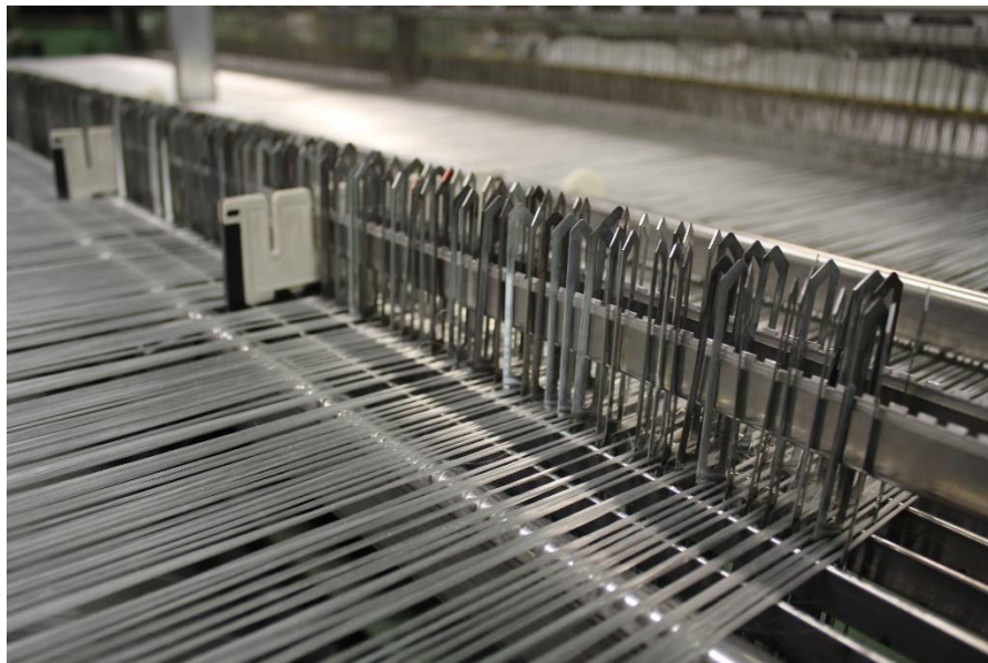
Obrázek 28: Nasazené lamely na osnovních nitích.
