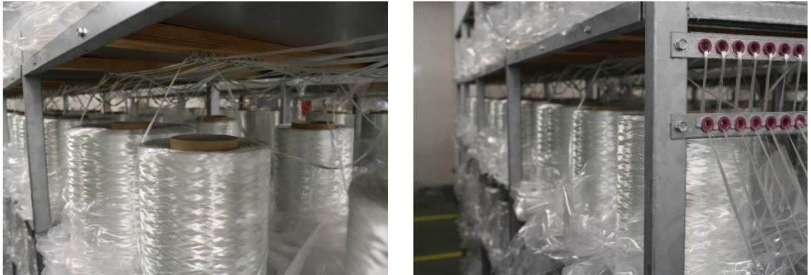
Obrázek 16: Navedené osnovní nitě ve vodících očkách.
