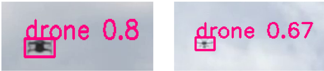
(a) Klasifikácia Natrénovaného Typu Drona (b) Klasifikácia Nenatrénovaného Typu Drona
