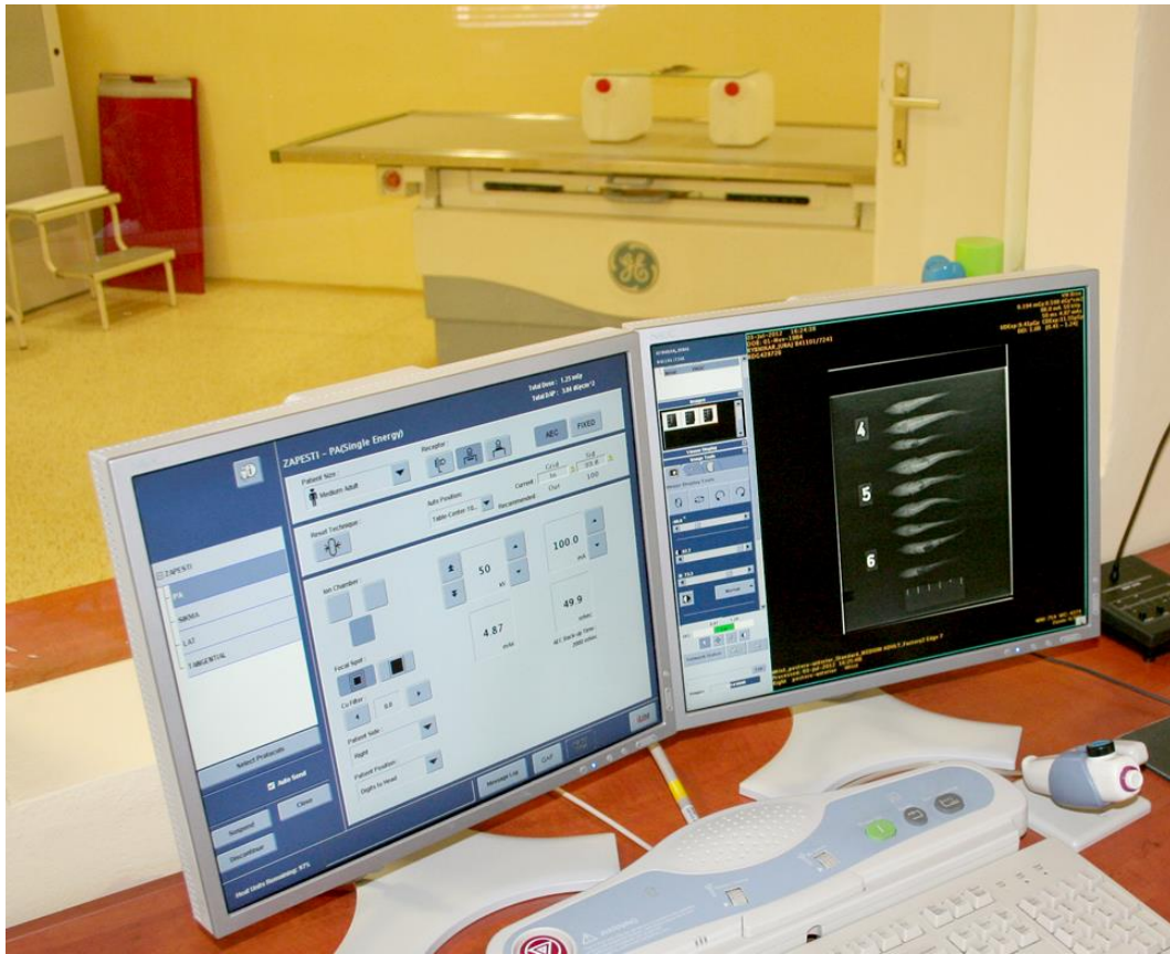
Obrázok 21: Pohľad na časť skiagrafického prístroju pri snímkaní. V pozadí sú vidieť jesetery na digitálnej doske s citlivosťou na röntgenové žiarenie.
