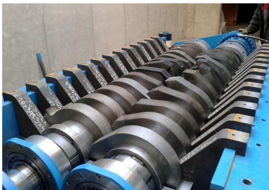
Obrázek 2 - Pohled na dvouhřídelový drtič DRU 2400 s přítlakem značky Odes [5]
