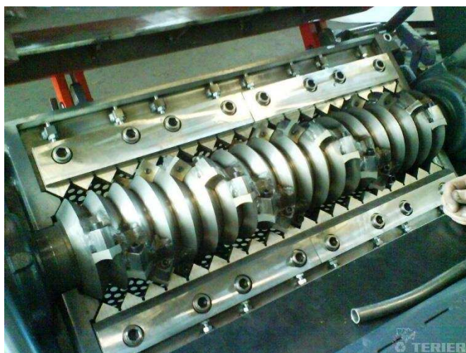
Obrázek 1- Pohled na jednohřídelový drtič značky TERIER[4]
