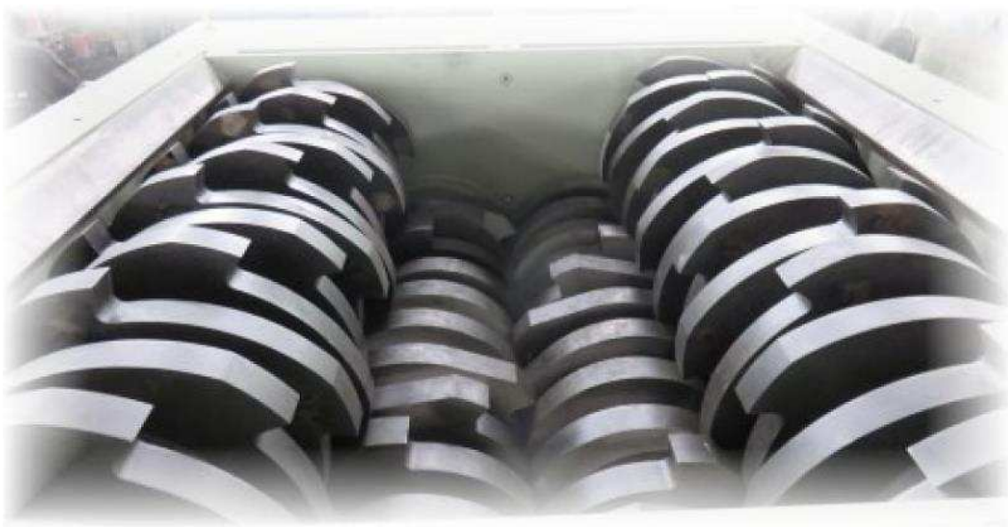
Obrázek 3 - Čtyřhřídelový drtič značky TOPMACHINES [15]
