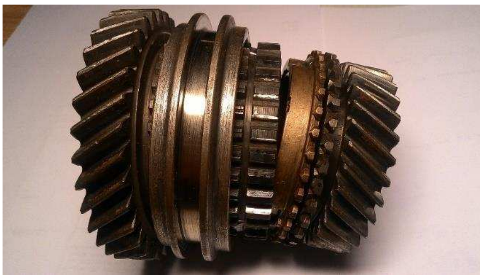
Obrázek 10 - Synchronizační spojka s ozubenými koly
