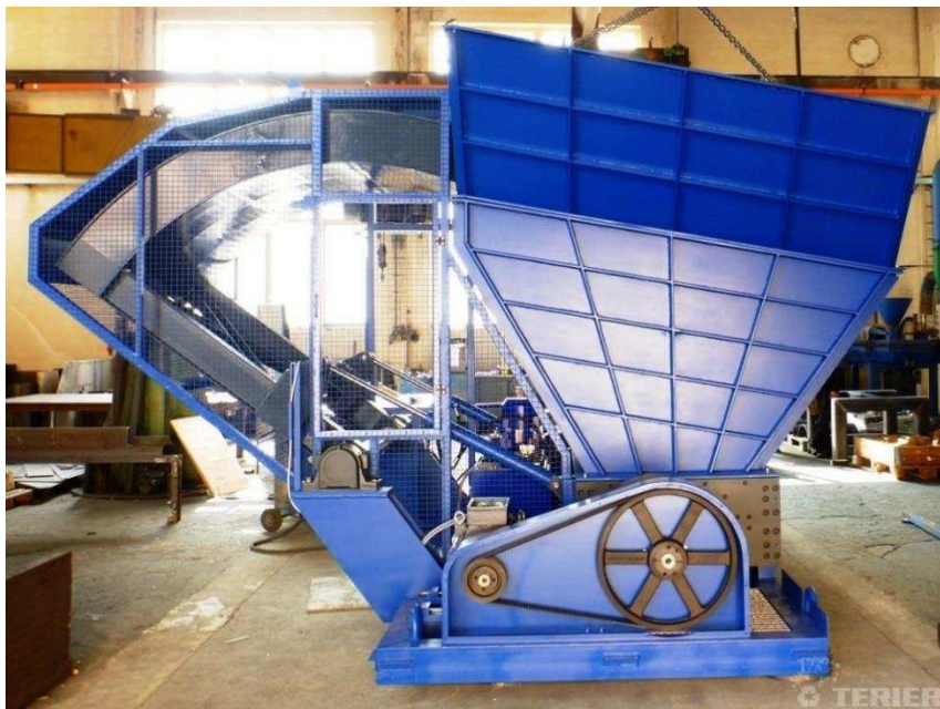
Obrázek 5 - Pohled na řemenový převod drtiče značky TERIER [7]
