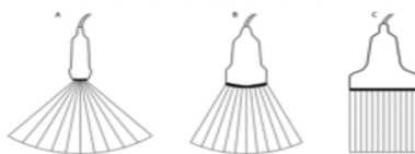
Obrázek 4 Ultrazvukové sondy: sektorová (A), konvexní (B), lineární (C)
