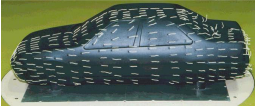
Obrázok 21 Vizualizácia oddelenej oblasti prúdenia na aute pomocou chumáčov [20]
