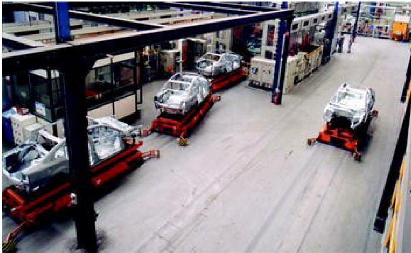
Obr. 1.2 Automobilová výroba VW s použitím AGV v roce 1986
