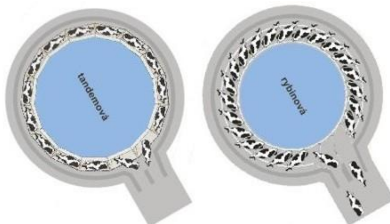
Obr. 4: Rotační dojírny: tandemová a rybinová (Lukrom-milk.cz)
