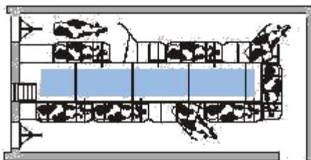
Obr. 2 - tandemová dojírna (Lukrom-milk.cz)
