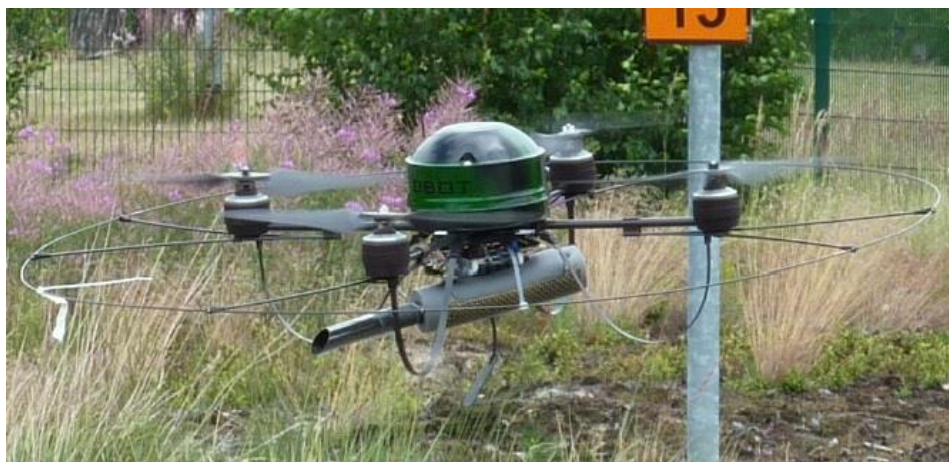
Obrázek č. 19 Dron s plyno-citlivým nosem (URL 19)
