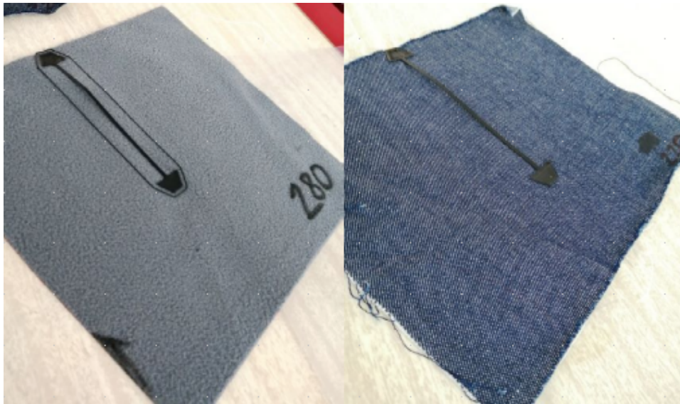
Obrázek 27: Porušené vodivé drahy po praní - vzorky 2P a 3T.
