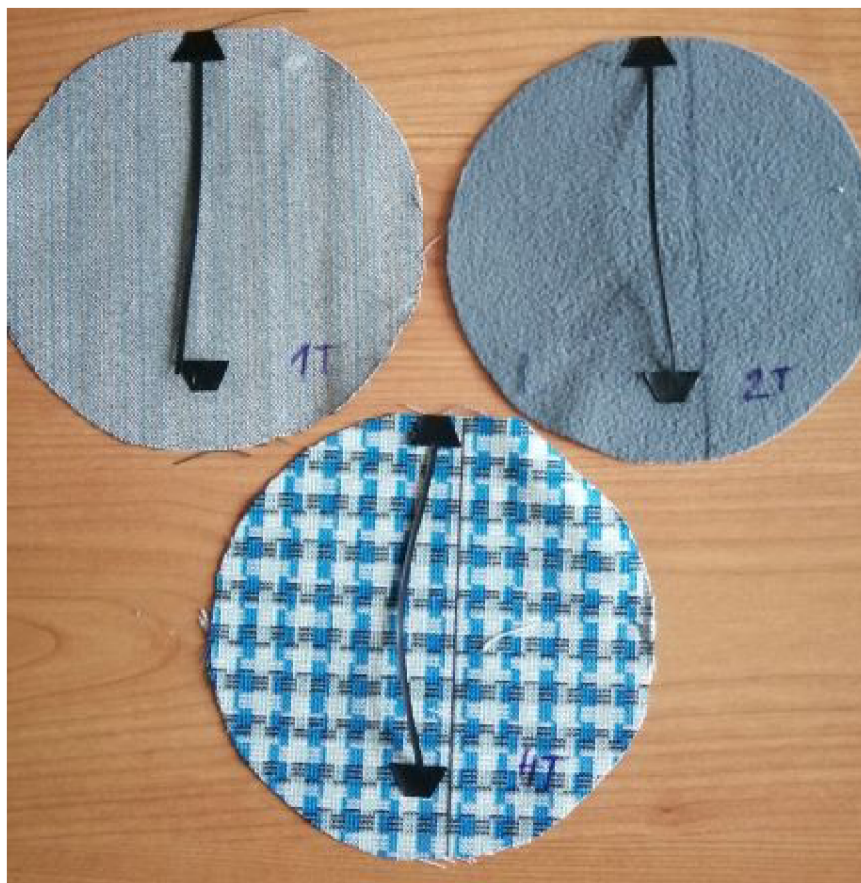
Obrázek 37: Vzorky potištěné TPU strunou po zkoušce odolnosti oděru.
