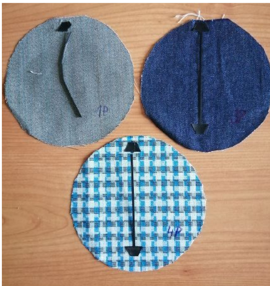
Obrázek 36: Vzorky potištěné PLA strunou po zkoušce odolnosti oděru.
