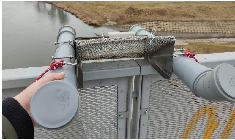
Obrázek 17: Finální podoba "manty" s kovovou sítí u vstupu (foto: autorka)
