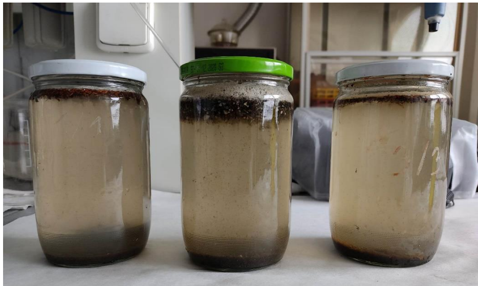
Obrázek 18: Vzorky z odběrů pomocí "manta" sítě, vzorkovnice o objemu 0,7 l (foto: autorka)
