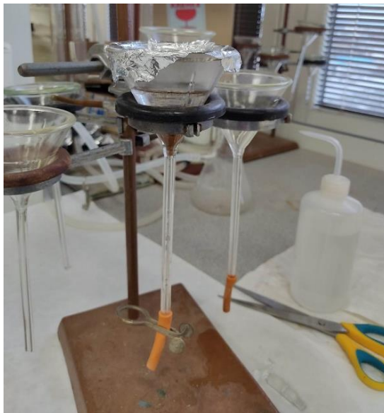
Obrázek 21: Aparatura na hustotní separaci (foto: autorka)
