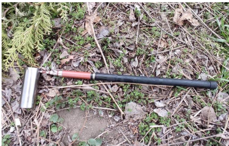
Obrázek 13: Teleskopická tyč s odběrovou nádobou z nerez (foto: autorka)
