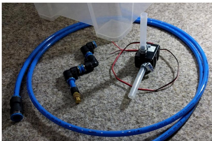
Obrázek 25 - Prvky vodního systému (vlastní zpracování)
