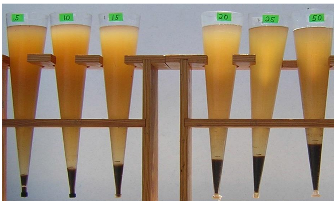
Obrázok 3: Imhofove kónusy na meranie biofloku ako častíc, ktoré sa usadia po 10 - 50 minútach (Hargreaves, 2013).
