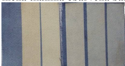
Bavlněná tkanina 0,5 % vybarvení před a po ozáření různou plošnou hustotou energie (obarvený bez ozáření; 6,96; 4,97; 2,97; 1,99 a 0,99 J.cm^{-2} )
