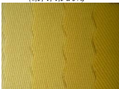
Bavlněná tkanina obarvená kypovým barvivem C. I. Vat Yellow 2 (0,5; 1; 1,5 a 3%)
