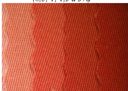
Bavlněná tkanina obarvená kypovým barvivem C. I. Vat Red 13 (0,5; 1; 1,5 a 3%)
