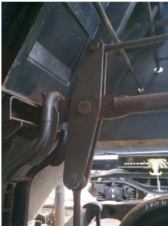
Obr. 11 Natáčecí rameno brzdových táhel s vedením a převodnicí vozu Taoos (vlastní foto)
