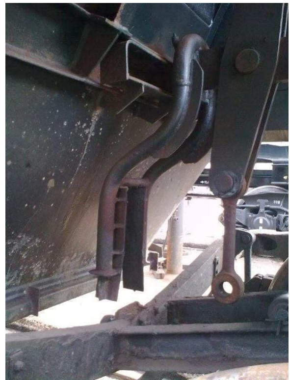
Obr. 11 Natáčecí rameno brzdových táhel s vedením a převodnicí vozu Taoos (vlastní foto)
