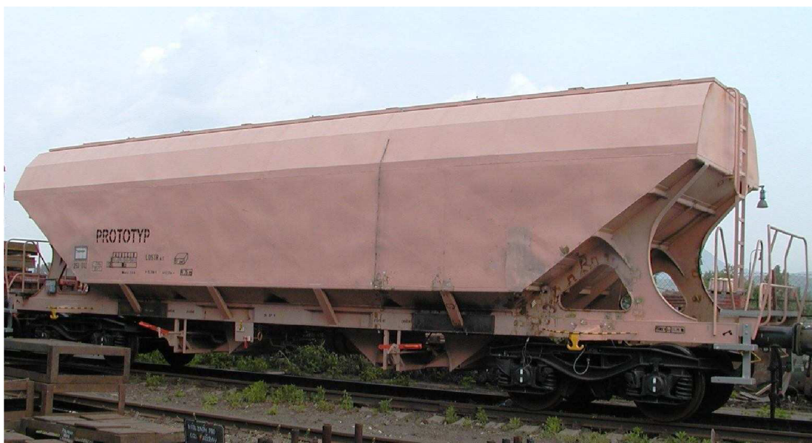
Obr. 1 Nákladní železniční vůz Tagnpps (vlastní fotografie)
