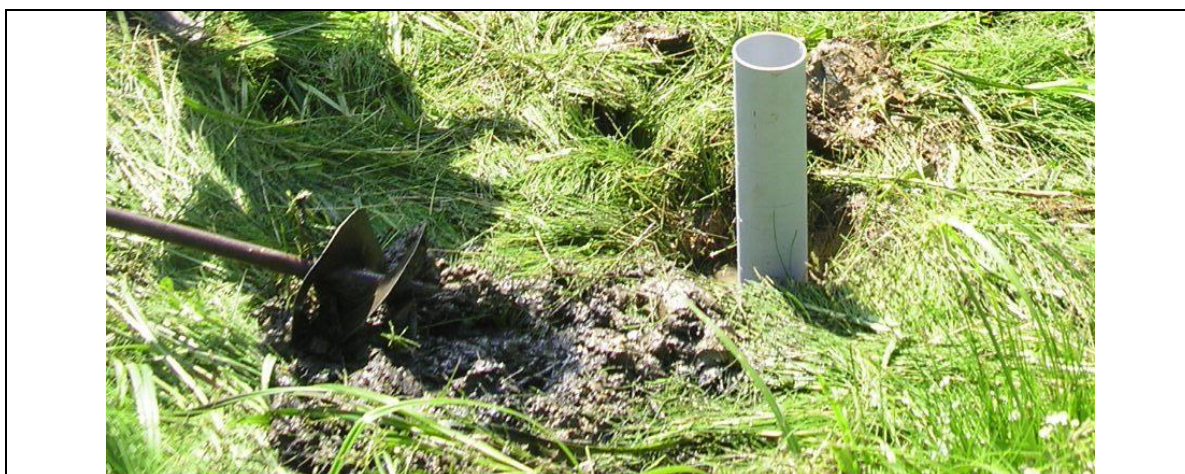
Obr. č. 4-4: Sonda HM2 s výstrojí z PVC; vlevo - materiál z tělesa mokřadu
