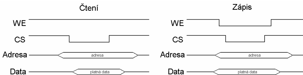
Obrázek 3. Průběh signálů při zápisu/čtení v SRAM
