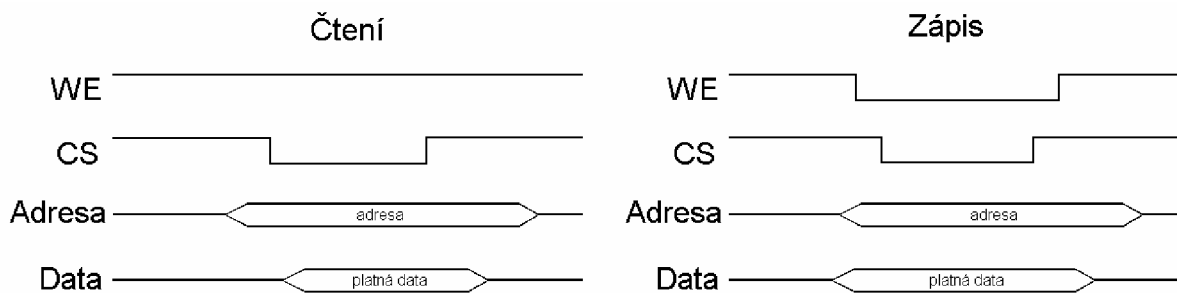
Obrázek 3. Průběh signálů při zápisu/čtení v SRAM
