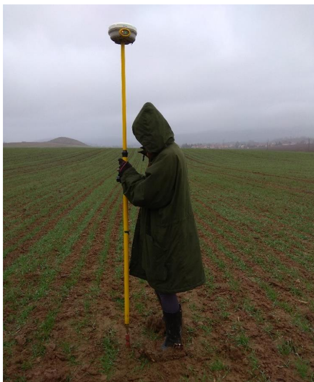
Obrázok 9 Meranie GNSS aparátúrou Trimble R4 [autor]
