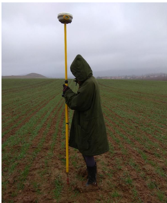
Obrázok 9 Meranie GNSS aparátúrou Trimble R4 [autor]
