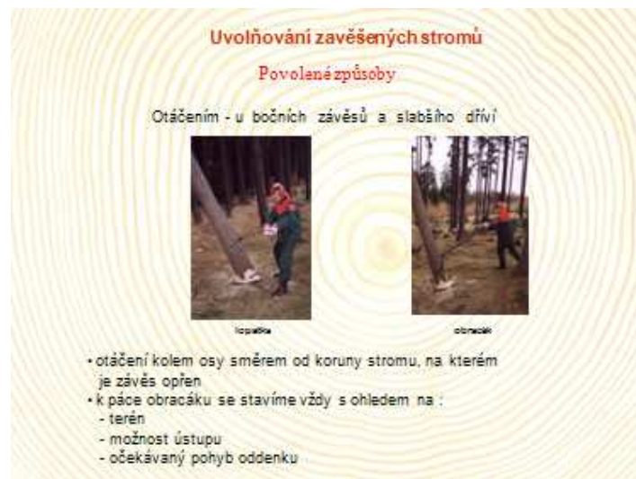
(Obr. 2 Povolené způsoby odstraňování zavěšených stromů.)
