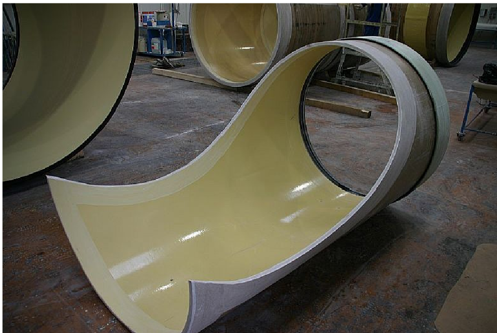
Obr. č. 9 - Sklolaminátové potrubí Hobas [12]
