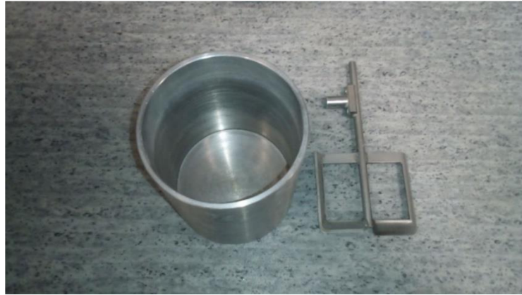
Obrázek 10: Měřicí soustava pro stanovení reologických vlastností
