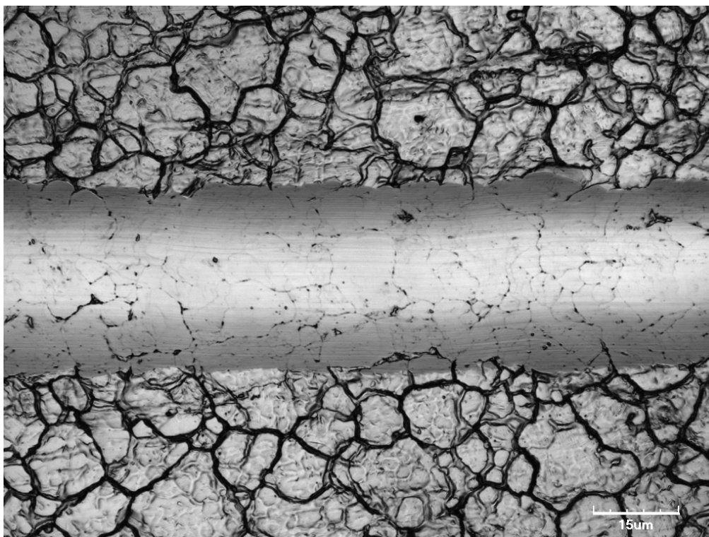
Obr. 36: Snímek čisté oceli z konfokálního mikroskopu po scratch testu. Rýha je hladká po celé délce vrypu. Nejsou viditelné nánosy materiálu. Dochází k vtažení materiálu. Průřez rýhy je kruhový.
