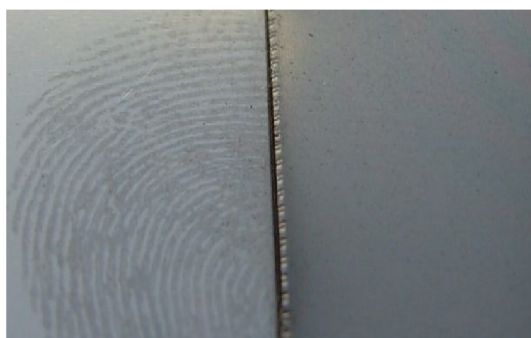
Obr. 28: Srovnání otisku prstu na nepokryté a pokryté oceli vrstvou pp-HMDSO
