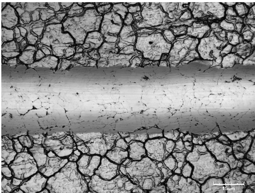
Obr. 36: Snímek čisté oceli z konfokálního mikroskopu po scratch testu. Rýha je hladká po celé délce vrypu. Nejsou viditelné nánosy materiálu. Dochází k vtlačení materiálu. Průřez rýhy je kruhový.
