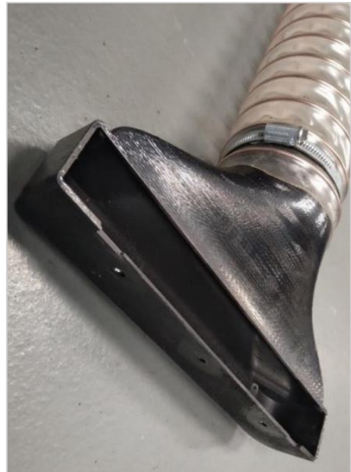
Obr. 3.5 Nástavec k odsávání prachu
