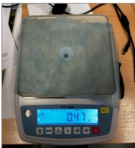
Obr. 3.10 Vážení filtru před frézováním
