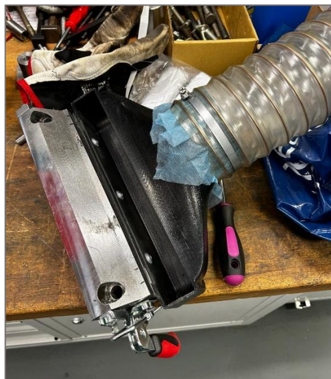
Obr. 3.8 Ukázka ustavení filtru mezi hadicí a nástavcem
