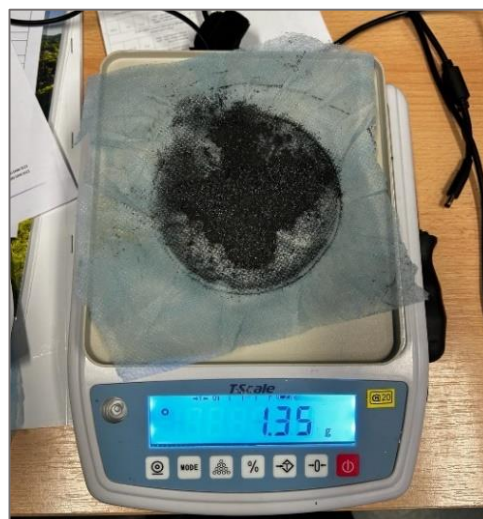
Obr. 3.11 Vážení filtru po frézování
