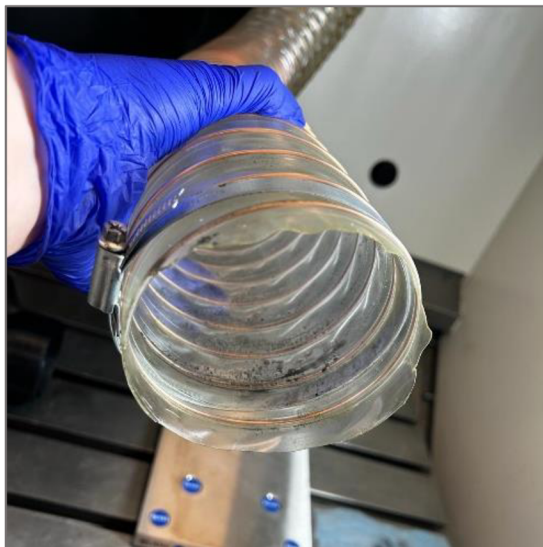
Obr. 3.9 Sběr částic z ústí hadice po ukončení experimentu
