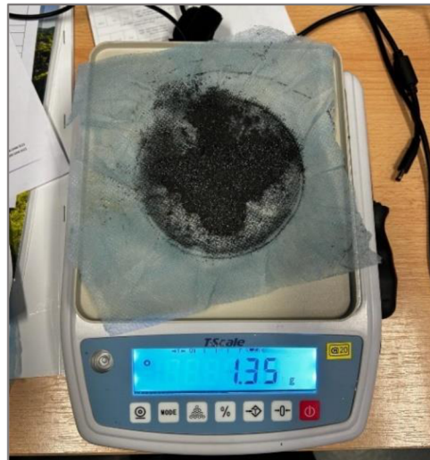
Obr. 3.11 Vážení filtru po frézování
