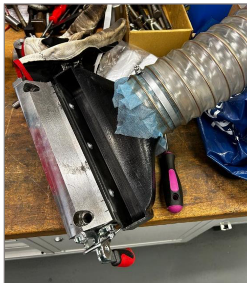
Obr. 3.8 Ukázka ustavení filtru mezi hadicí a nástavcem
