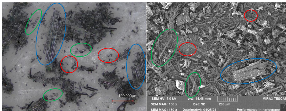
Obr. 4.2 Typy prachových částic ze SEM
