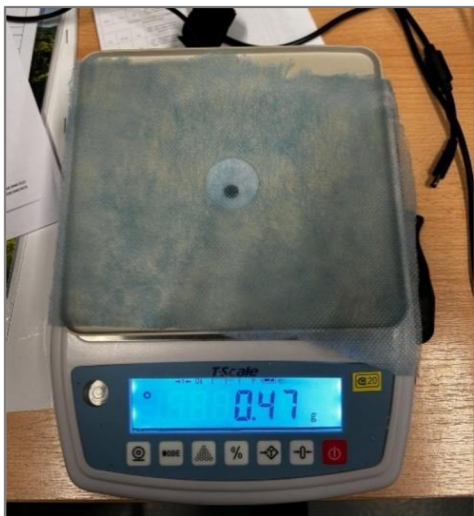
Obr. 3.10 Vážení filtru před frézováním
