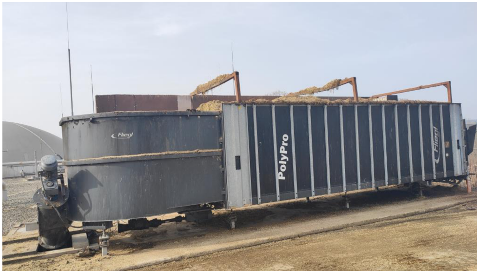
Obr. 4.2 Dávkovač na biomasu; zdroj: fotografie autora
