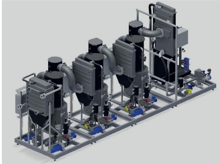
Obr. 2.6 Vícestupňové uspořádání odparky MKR DV1000/2000; převzato z [20]
