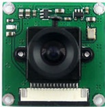
(a) Raspberry Pi kamera, která je připojena do desky Raspbbery Pi. 1
