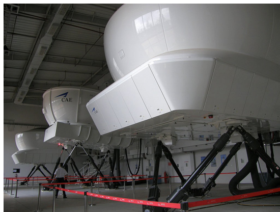
Obrázek 2.2: Praktické využití Stewartovy platformy v leteckém simulátoru. 2
