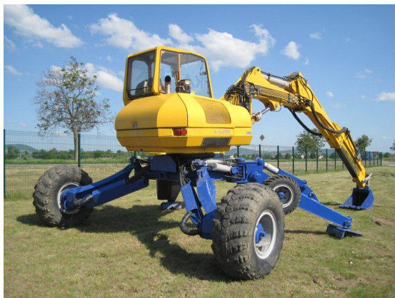
Obrázek 1.3: Kráčivý bagr. Díky svým končetinám může pracovat i v členitém terénu. 3
