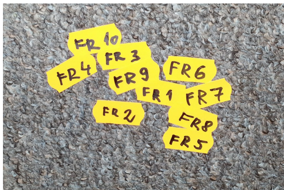
Obrázek 6.1: Výsledné pozice pravé přední končetiny v testu opakovatelnosti pohybu. Každá z nálepek odpovídá koncové pozici pravé přední končetiny při jednom z testů. Z obrázku je vidět, že vzdálenosti mezi jednotlivými nálepkami jsou minimální. Směrodatná odchylka jednotlivých testů činí pouze 21,72 mm v ose x a 14,45 mm v ose y.
