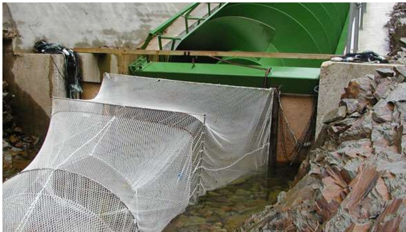
Obr. č. 20. – Ichtyologický výzkum Archimédovy turbíny
