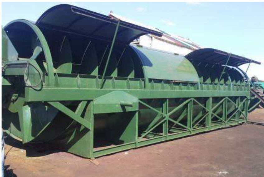
Obr. č. 25. – Příklad zakrytí Archimédovy turbíny pro vodní elektrárnu Pilec v Polsku
