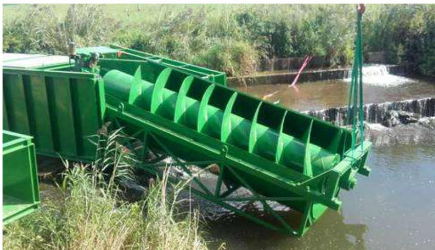
Obr. č. 27. – Příklad instalace kompaktního řešení Archimédovy turbíny ( http://archimedespower.co.uk/index.php?id=news&idd=35&lang=eng )
