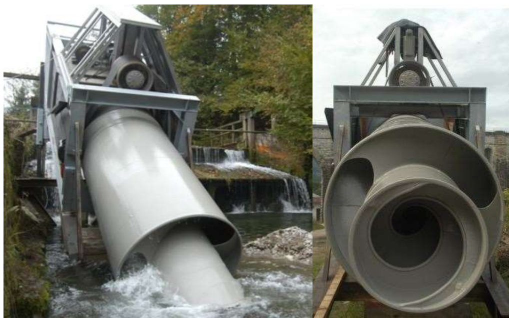
Obr. č. 29. – Příklad instalace prototypu nové Archimédovy turbíny s rybím výtahem ( http://www.xn--iws-una.de/wp-content/uploads/Praxishandbuch )
