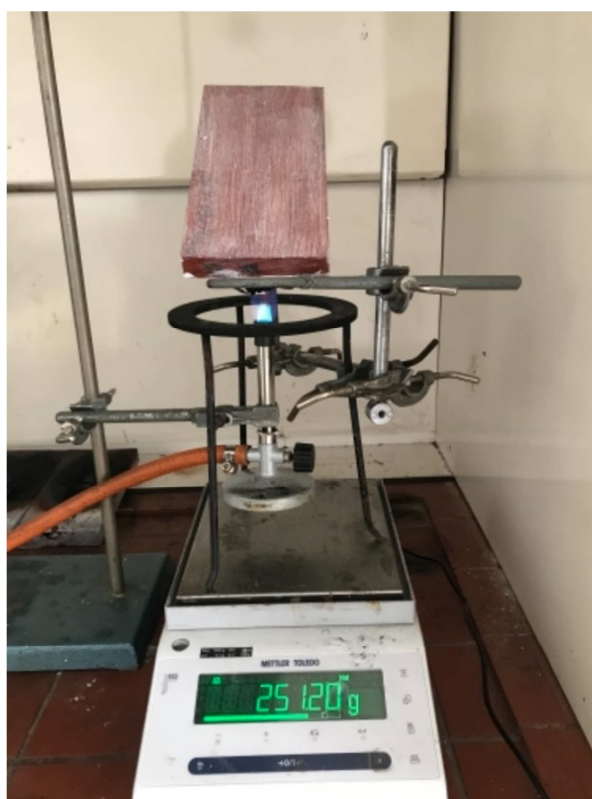
Obr. 15: Měření úbytku hmotnosti při hoření na vzorcích s protipožárním nátěrem
