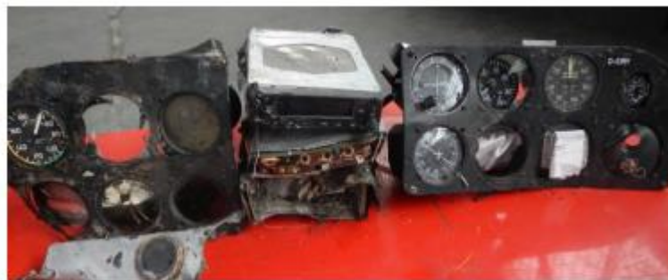
Obr. 11 - Sestava nalezených částí palubní desky
