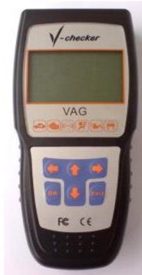
Obrázek č. 1.16: Diagnostický přístroj VAG (určený na diagnostiku vozů koncernu VW) (eshop-rychle.cz, 2020)
