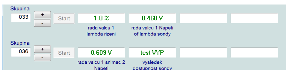
Obrázek 4.6: Napětí lambda sond (Diagnostický přístroj VAG, 2020)
