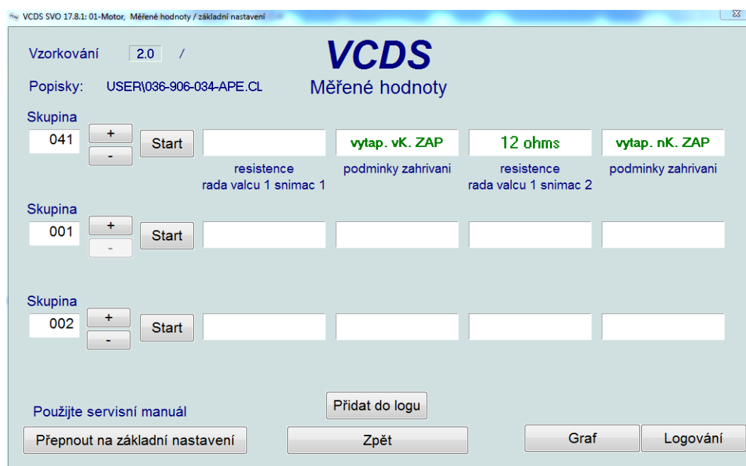
Obrázek 4.4: Vyhřívání lambda sondy (Diagnostický přístroj VAG, 2020)
