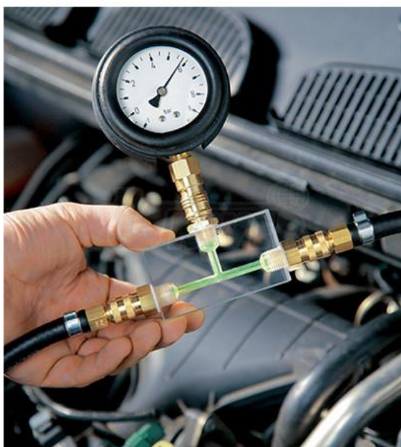
Obrázek č. 1.14: Měření tlaku palivovém potrubí (Univer.cz, 2020)
