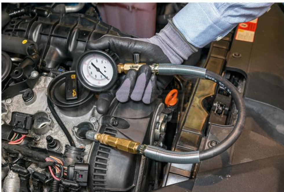
Obrázek č. 1.15: Měření kompresních tlaků (Univer.cz, 2020)
