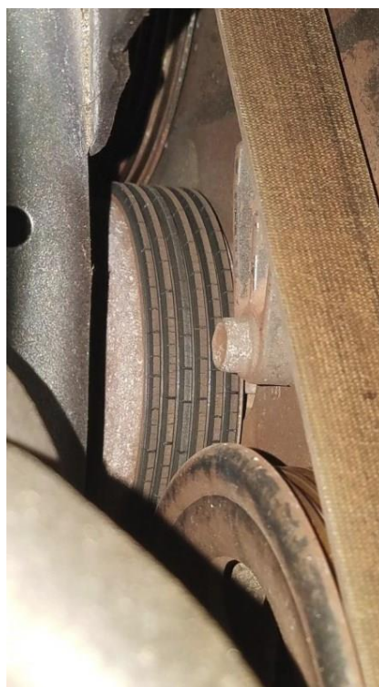
Obrázek 1.6: Subjektivní kontrola popraskaného drážkového řemene (hmjauto.cz, 2020)
