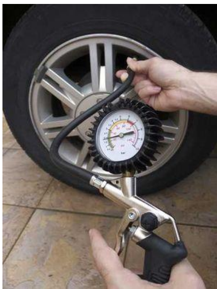
Obrázek č. 1.13: Měření tlaku v pneumatikách (Pneuleader.cz, 2020)
