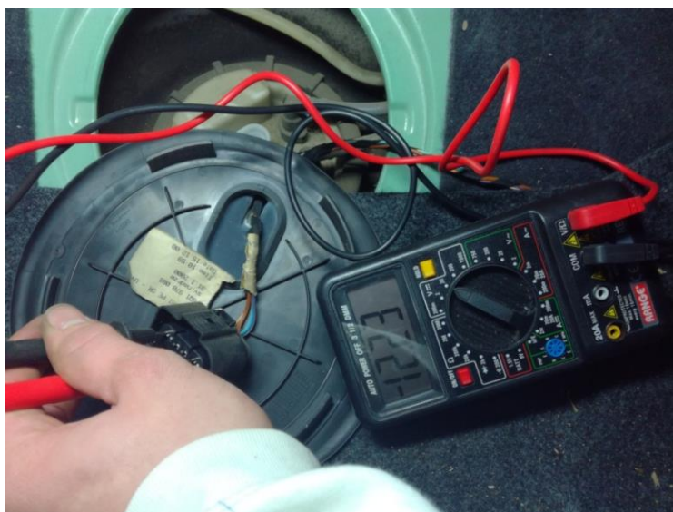
Obrázek 4.18: Napětí palivového čerpadla
