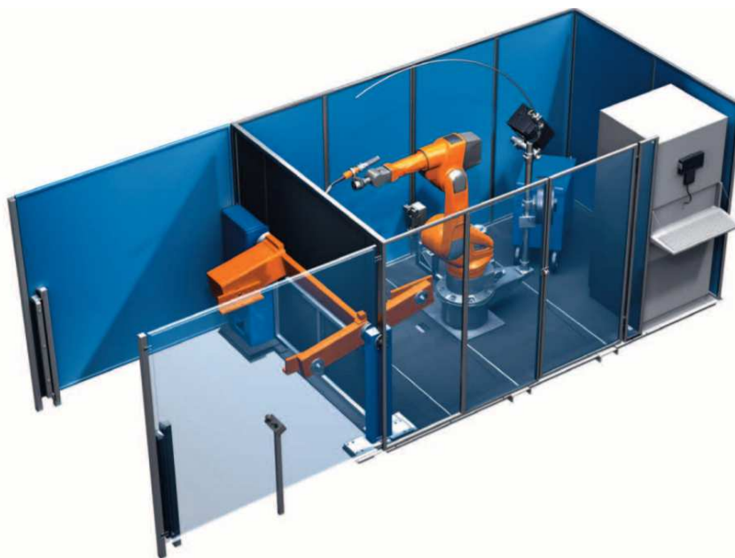
Obr. 38 Svařovací pracoviště firmy CLOOS [33]
