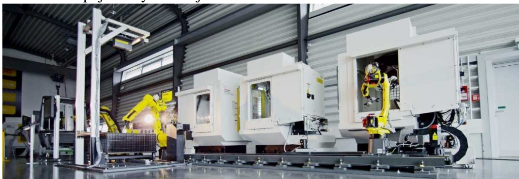
Obr. 39 Robotizovaná obsluha více strojů jedním robotem [34]
