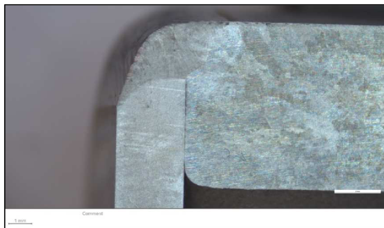
Obr. 72 Vzorek B – koutový svar z2 [4]
