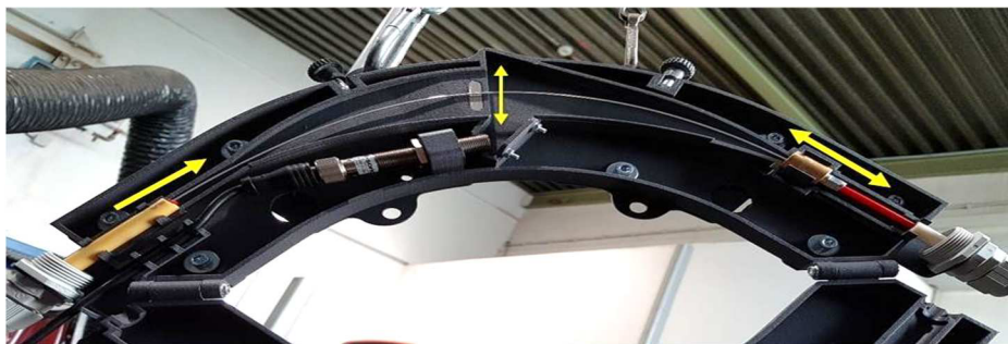
Obr. 26 Řez vyrovnávacím zařízením [29]
