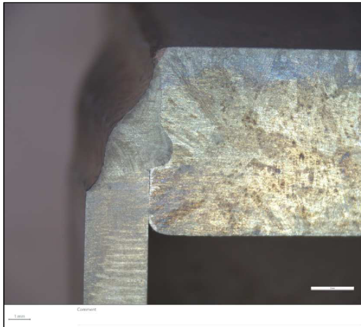
Obr. 71 Vzorek B – koutový svar z3 [4]
