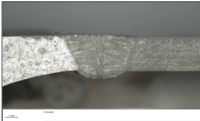
Obr. 66 Vzorek A – tupý svar [4]
