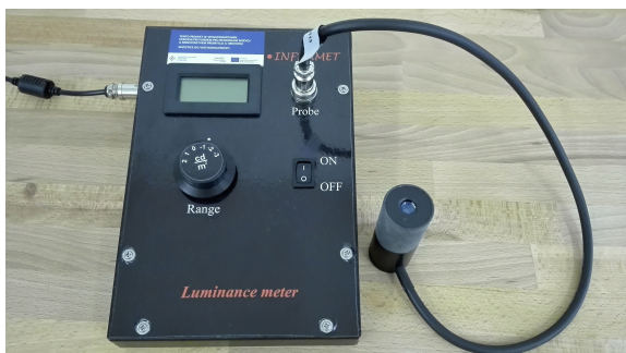
(a) Jasoměr od firmy Inframet
