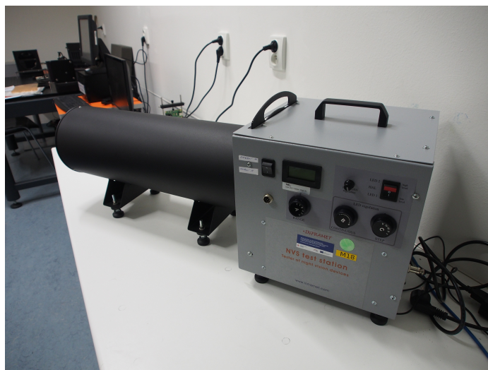
Obrázek 12: Měřicí sestava – vpravo: LAN light source, vlevo: kolimátor.
