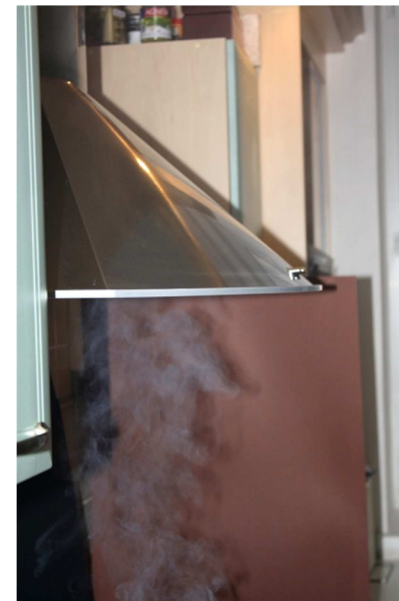
Obr. 47 Proudění kouře s odsáváním
