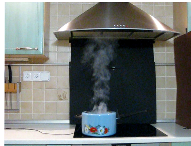
Obr. 49 Proudění kouře s odsáváním – čelní pohled
