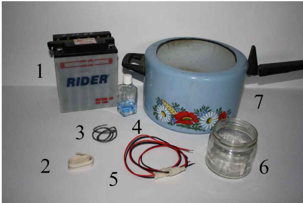
Obr. 6 Komponenty nutné k výrobě generátoru kouře
