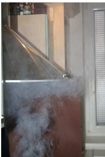
Obr. 13 Vývin páry bez sepnutého odsávání
