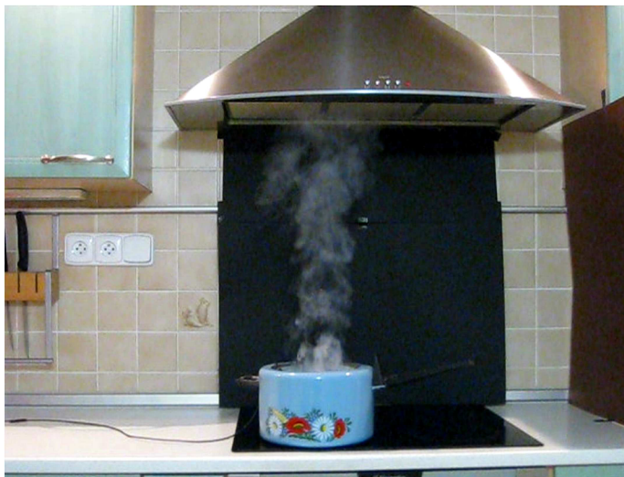
Obr. 12 Vývin páry se sepnutým odsáváním na nejvyšší otáčce- čelní pohled
