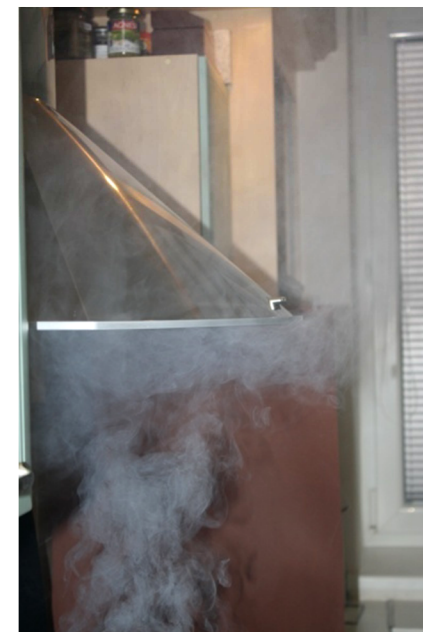
Obr. 43 Proudění kouře bez odsávání – boční pohled
