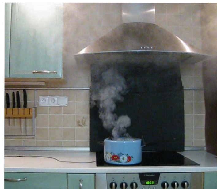
Obr. 45 Proudění kouře bez odsávání – čelní pohled
