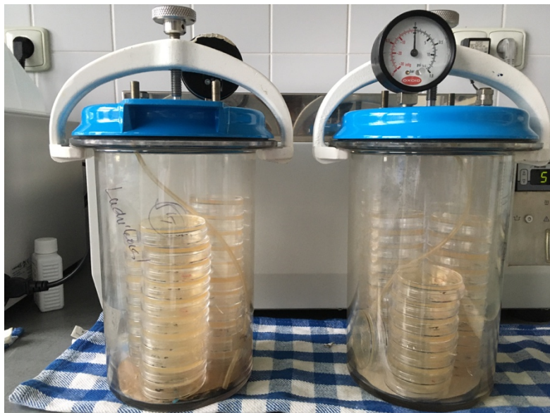
Obrázek 19: Petriho misky v boxu s anaerobním vyvíječem
