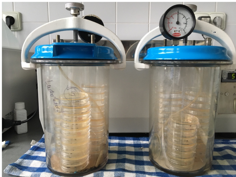
Obrázek 19: Petriho misky v boxu s anaerobním vyvíječem
