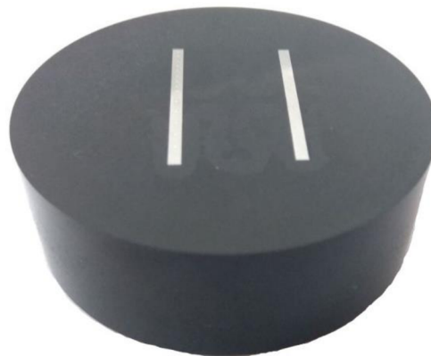
Obr. 3.9 Zalisovaný vzorek TRIP ocele [Vlastní]
