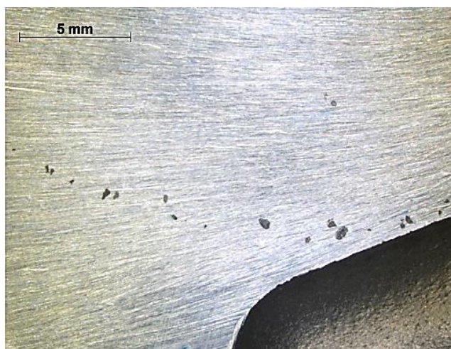
Obr. 30: Rozložení vměstků v horizontálním směru po broušení [zdroj: vlastní]
