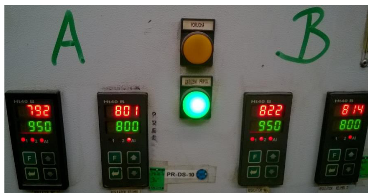
Obr. 19: Teploty termočlánků v tavní peci [zdroj: vlastní]
