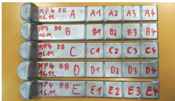
Obr. 54: Vzorky K-forma, udržovací pec KP4, odlité z tekutého zbytku
