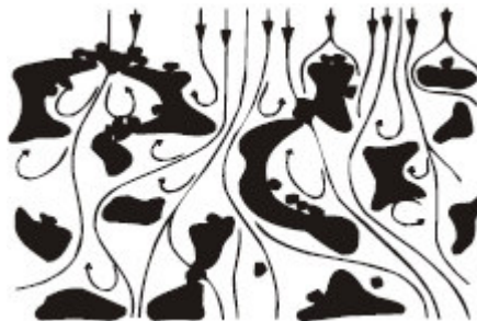
Obr. 5: Víření taveniny ve struktuře filtru [17]
