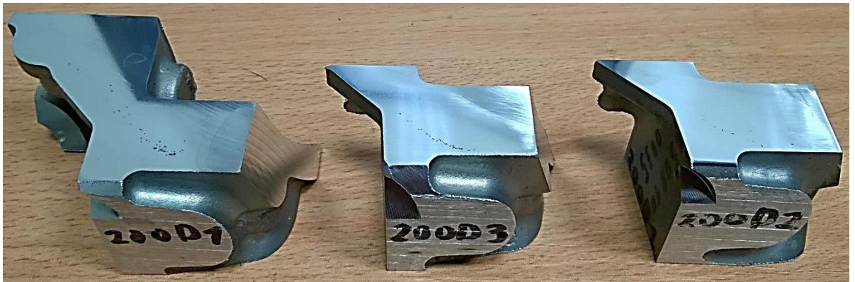
Obr. 27: Postižené části odlitku [zdroj: vlastní]
