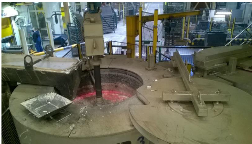
Obr. 25: Odplyňování taveniny [zdroj: vlastní]
