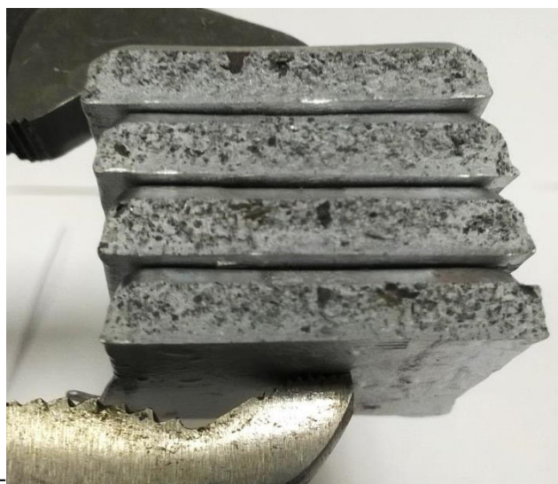
Obr. 59: Vzhled lomových ploch vzorku KP3-DOL-E [zdroj: vlastní]
