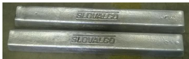
Obr. 2: Ingoty hliníkové slitiny AlSi7MgCu0,5 firmy Slovalco [zdroj: vlastní]
