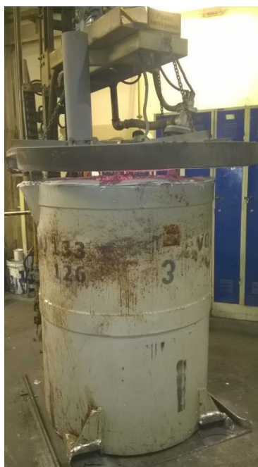
Obr. 20: Předehřev pánve [zdroj: vlastní]
