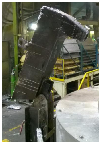
Obr. 21: Přelévací žlab [zdroj: vlastní]
