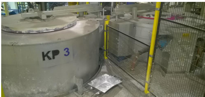
Obr. 23: Udržovací pece Hindenlang [zdroj: vlastní]
