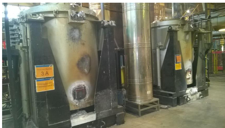
Obr. 18: Tavící plynové kelímkové pece Realistic [zdroj: vlastní]
