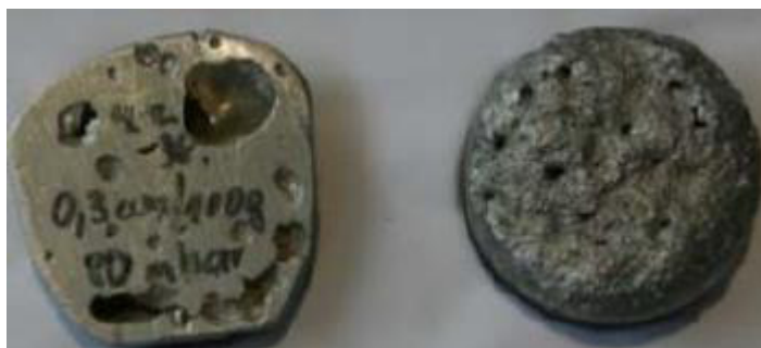
Obr. 14: Vlevo vzorek Straube-Pfeiffer, vpravo Drosstest [14]
