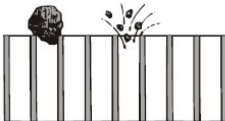
Obr. 3: Princip filtrace cezením [17]
