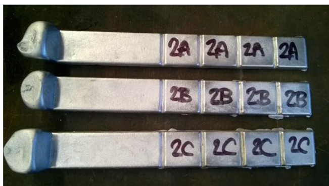
Obr. 60: Vzorky odlité do K-mold
