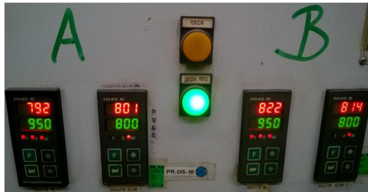
Obr. 19: Teploty termočlánků v tavní peci [zdroj: vlastní]
