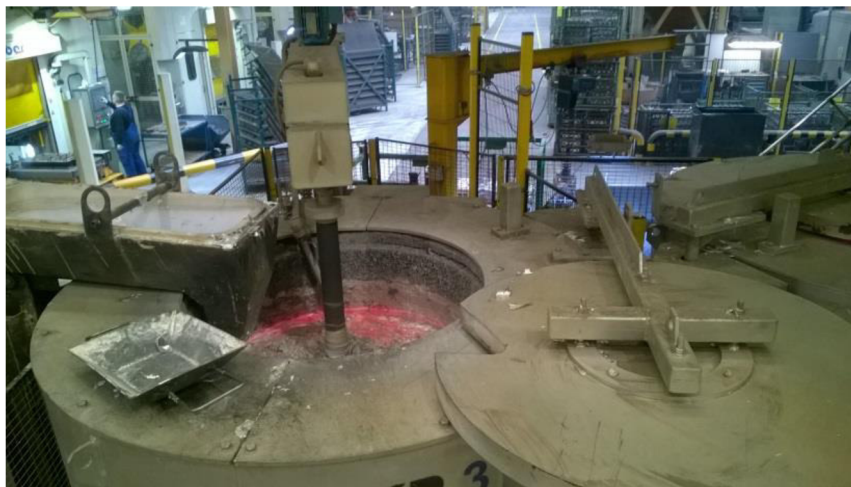
Obr. 25: Odplyňování taveniny [zdroj: vlastní]
