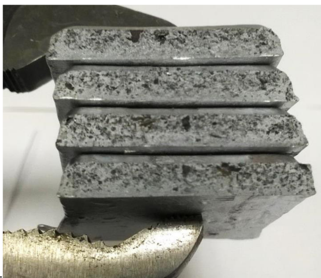
Obr. 59: Vzhled lomových ploch vzorku KP3-DOL-E [zdroj: vlastní]
