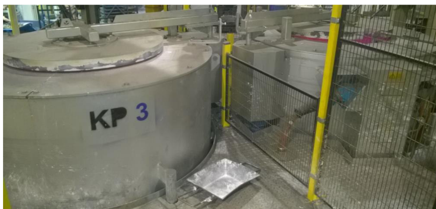
Obr. 23: Udržovací pece Hindenlang [zdroj: vlastní]
