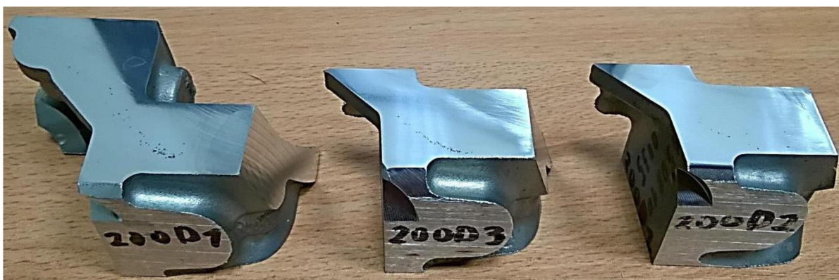
Obr. 27: Postižené části odlitku [zdroj: vlastní]
