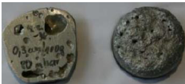
Obr. 14: Vlevo vzorek Straube-Pfeiffer, vpravo Drosstest [14]
