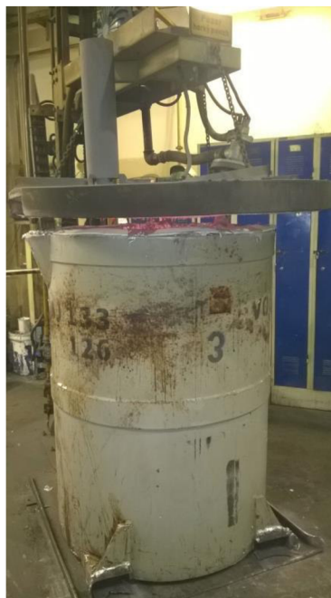
Obr. 20: Předehřev pánve [zdroj: vlastní]
