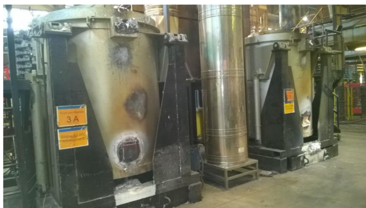
Obr. 18: Tavící plynové kelímkové pece Realistic [zdroj: vlastní]
