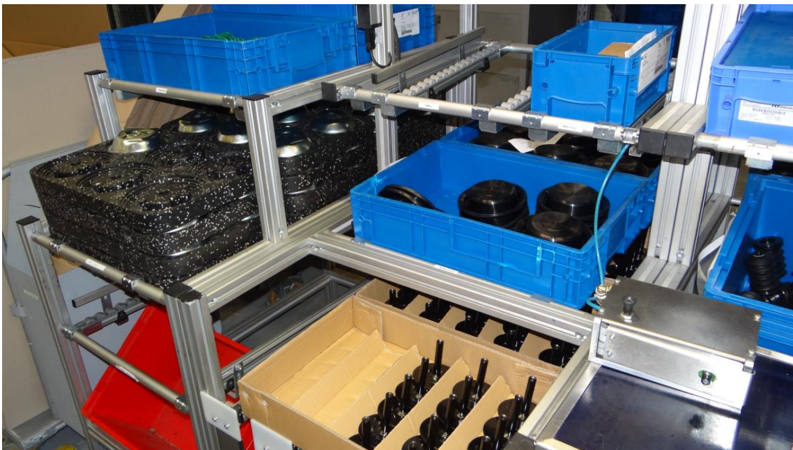
Obr.4.4.: Pracoviště přípravy před zavedení výroby tokem jednoho kusu
