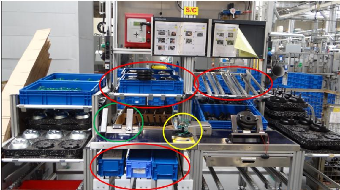
Obr.4.5.: Pracoviště přípravy po zavedení výroby tokem jednoho kusu
