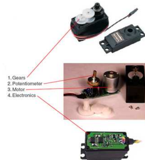
Obrázok 2.2: Pohľad do vnútra serva. 1. gears = ozubený prevod, 2. potentiometer = potenciometer, 3. motor = motor, 4. electronics = riadiaca elektronika 2
