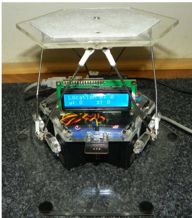
Obrázok 4.1: Fotografia výslednej vytvorenej Stewartovej platformy
