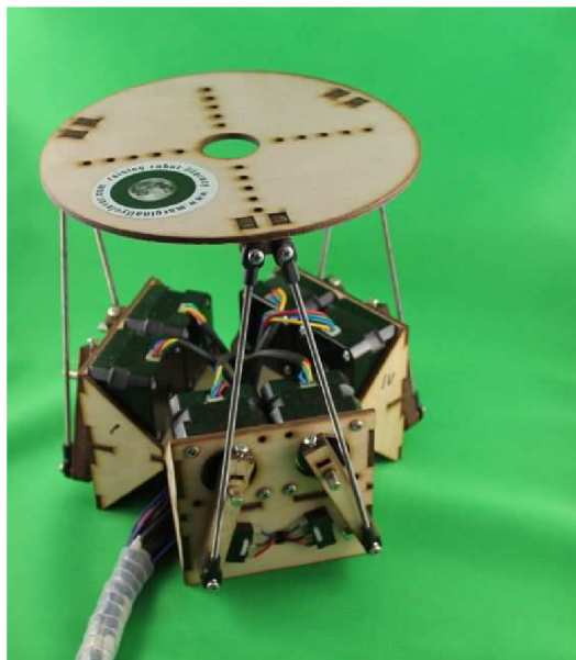
Obrázok 2.10: Stewartova platforma vytvorená od Marginally Clever
