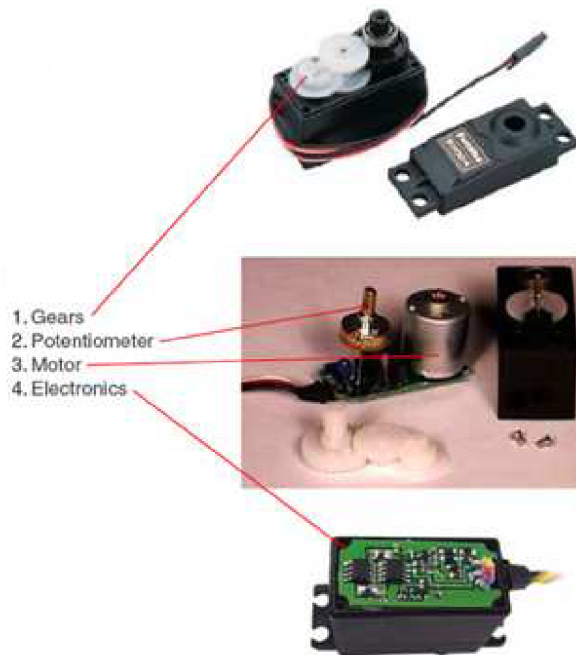
Obrázok 2.2: Pohľad do vnútra serva. 1.gears = ozubený prevod, 2. potentiometer = potenciometer, 3. motor = motor, 4. electronics = riadiaca elektronika 2
