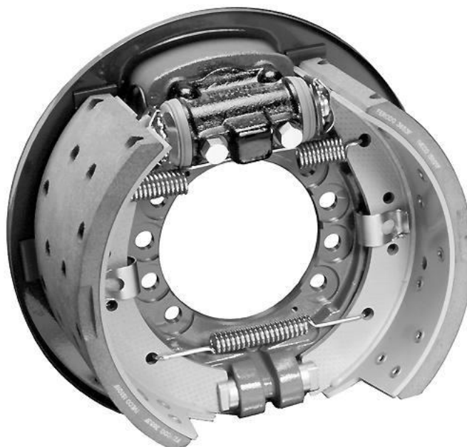
Obr. 5.: Konstrukce bubnové brzdy [9]
