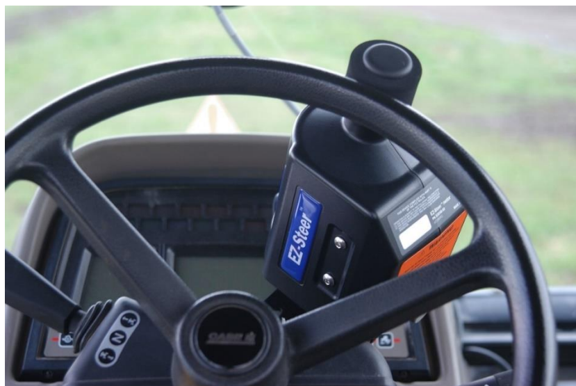
Obrázek č. 7: Asistovaný systém navádění pomocí přítlačného pastorku Trimble EZ-Steer (SprayerBarn, 2021)
